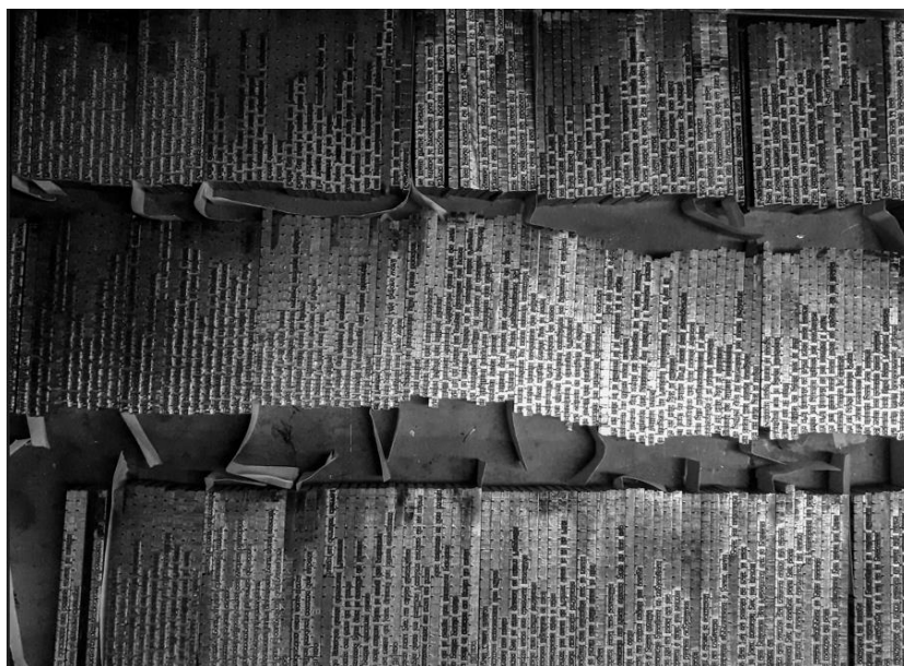
Galée remplie de lignes de plomb composées à la linotype pour l'impression typographique d'un recueil de poésie ©:Encrages & Co
