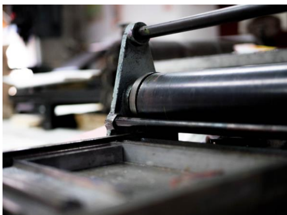
Détail de la presse à éprouve à l'atelier de Baume-les-Dames
